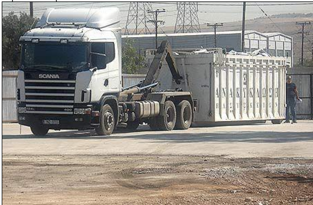
Εικόνα 17: Όχημα μεταφοράς κάδων τύπου ‘roll – open top container’ με υπερκατασκευή ‘hook-lift’
