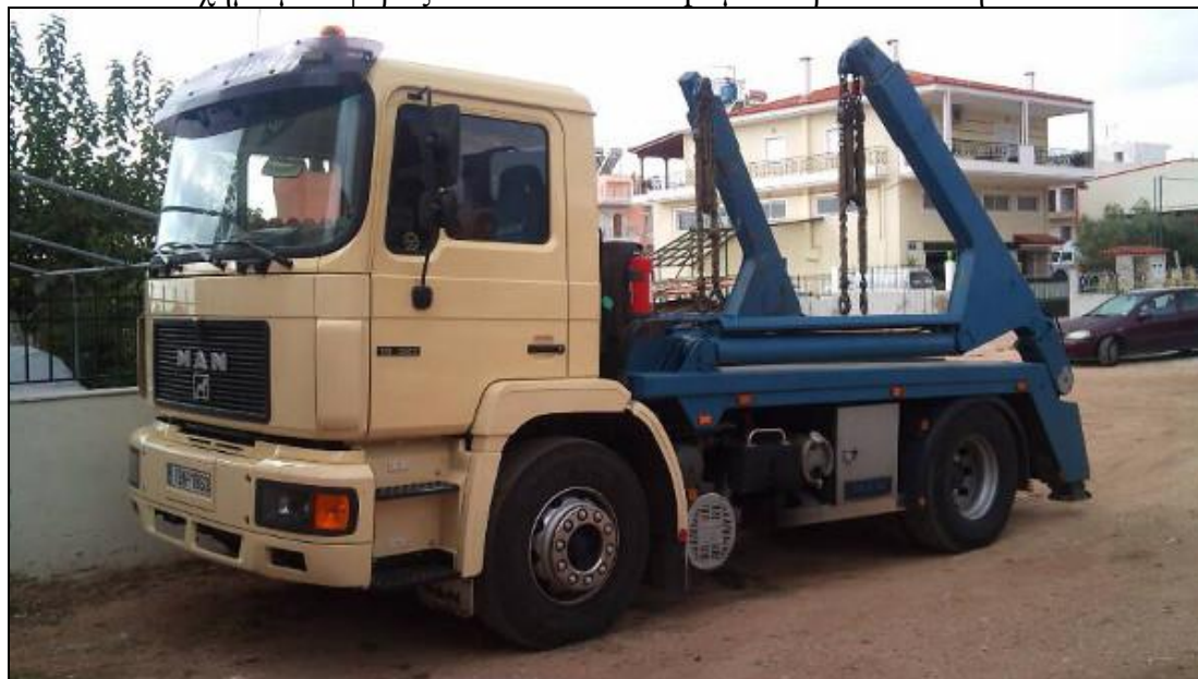
Εικόνα 18: Οχημα μεταφοράς κάδων τύπου ‘skip’ με υπερκατασκευή ‘αλυσιδάκι’
